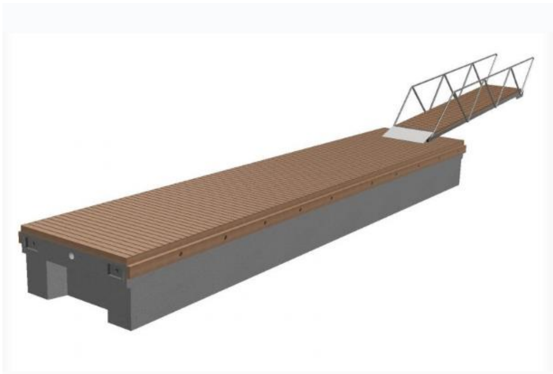
Figur 5. Principskiss över träbrygga med betongponton.
